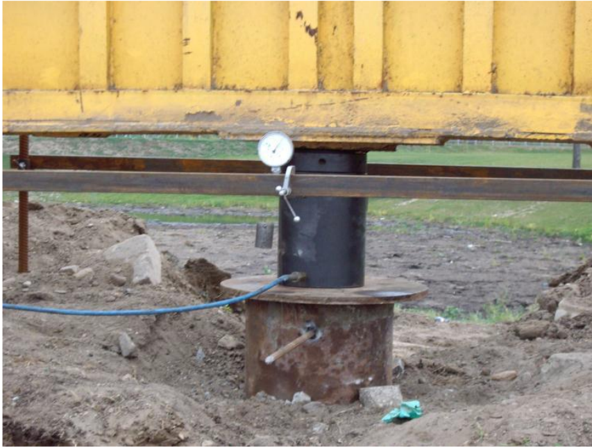
4 pav. Nuosėdžių matavimo indikatorius sumontuotas ant nepriklausomo sijyno Polių bandymo eiga
